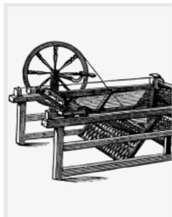
Nota: rueca (*spinning wheel*) e hiladora mecánica (*spinning jenny*). Fuente: D. Dorn (2015)
